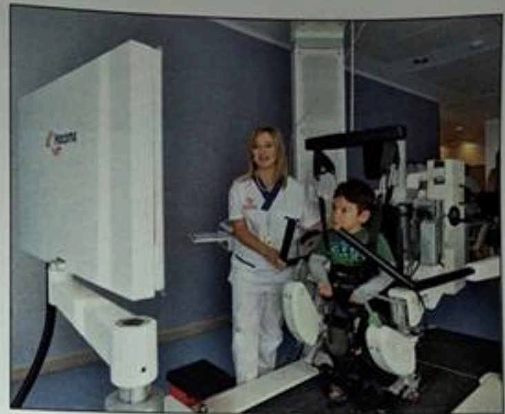
Figura 1 Training deambulatorio e del passo di un paziente affetto da paralisi cerebrale infantile con esoscheletro robotizzato per arto inferiore (Lokomat-PRO, pgc Hocoma).
