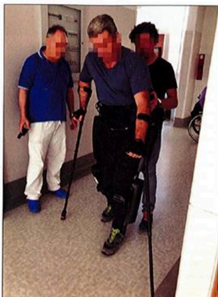
Figura 1 ReWalk: costituito da quattro attuatori, permette la flessione-estensione di anca e ginocchio.
