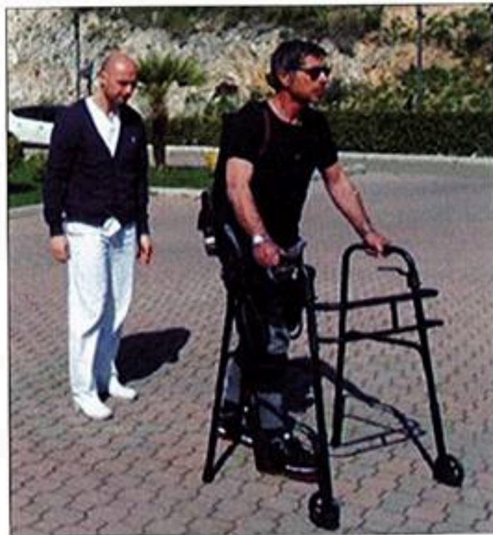
Figura 2 Ekso-GT: dotato di variable assist , in modalità adaptive permette ai pazienti di collaborare con il robot.
